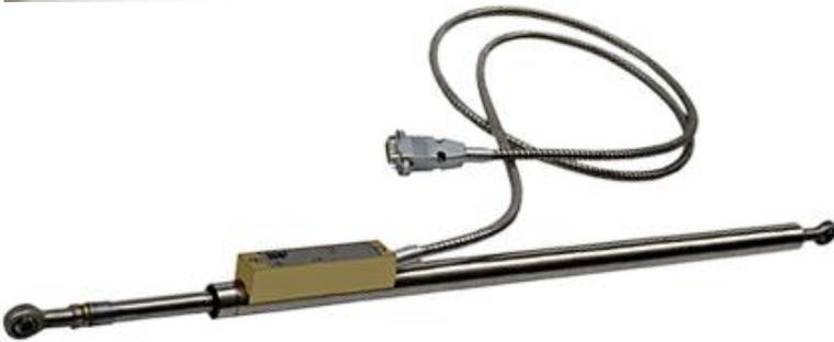
**Sensor Typ P** - teleskopische Ausführung wird von 100mm bis 800mm Messlänge und Auflösung 0.001mm im Schutzart IP54 hergestellt.
