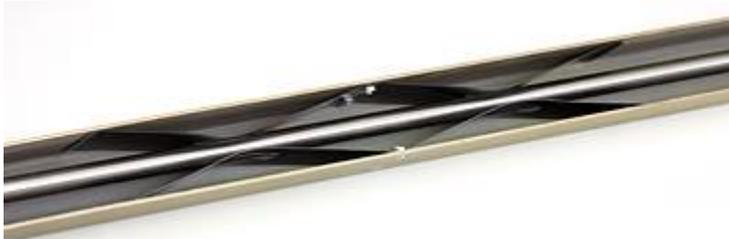
**Sensor Typ L** für lange Messstrecken wird in einem Schutzrahmen 40x40mm montiert. Die Federhalterung eliminiert das Durchbiegen der Messstange. Die Länge wird bis 5 Meter hergestellt.
