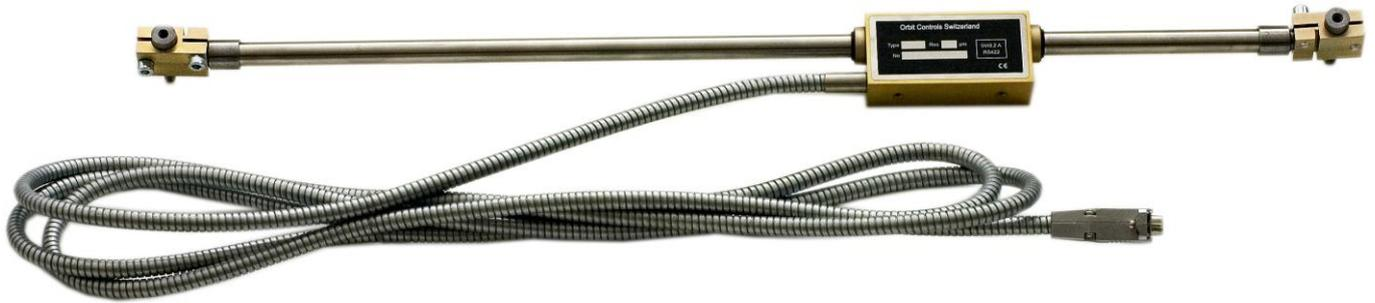
**Sensor Typ S** mit digitalem Quadratur-Ausgang RS422. Versorgung 5VDC-200mA. Auflösung bei Bestellung wählbar 0.001mm bis 0.5mm. Positioniergeschwindigkeit 1m/Sek. Als Option kann bis 7m/Sek. bestellt werden.
