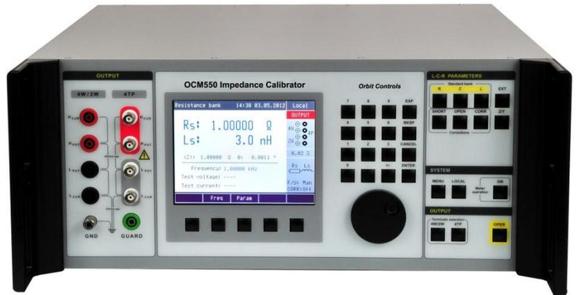
**Impedanzkalibrator OCM550** ist ein Laborgerät zur Kalibration von RLC Messbrücken. Er beinhaltet Dekaden von ultrastabilen Widerständen 100mΩ
