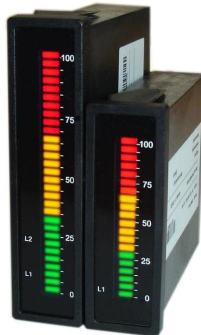
**OCB201 und OCB301** sind programmierbare Geräte mit 20 bzw. 30 Balkensegmenten zum Anschluss an analoge Prozesssignale bestimmt. Die Balkenfarbe rot, orange und grün kann frei über die ganze Balkenlänge kombiniert werden. Die Geräte sind für Schaltschrankbau zur Visualisierung von Prozessen bestimmt. Die Intensität der Balken kann in Schritten zwischen 20% und 100% gewählt werden.
