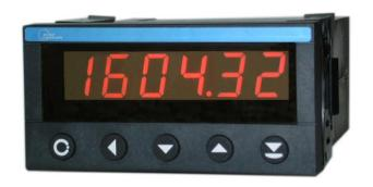
Tachometer - Frequenzzähler kann zum Messen von Drehzahlen, Geschwindigkeiten und anderen dynamischen Frequenzvorgängen eingesetzt und die Anzeige in Prozesseinheiten skaliert werden. Der Signaleingang kann aus einer oder zwei Signalquellen erfolgen. Werden die beiden Signaleingänge verwendet, kann die Drehzahl bidirektionell aus angeschlossenen Quadraturgebern ausgewertet werden. Als Timer kann auch die Periodendauer gemessen werden.
