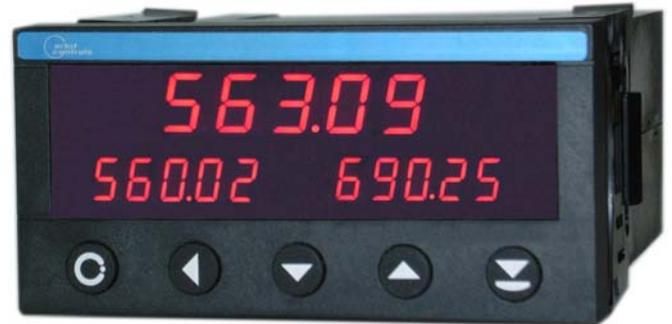
**Modell OC 7171A-I-3D** ist ein programmierbares Gerät für zeitliche Integration von Analogsignalen. Das Gerät verfügt über drei 5-stellige Anzeigen welche frei diversen Funktionen zugeordnet werden können.
