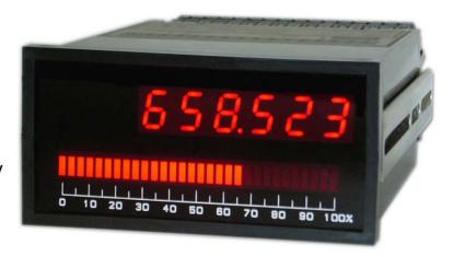
Modell OC7167 ist ein programmierbarer Zähler mit einer Digitalanzeige und einer Balkenanzeige. Die digitale Anzeige hat 6 Stellen. Im Messmode werden fünf Stellen verwendet, im Programmiermode werden alle sechs Stellen aktiviert.
