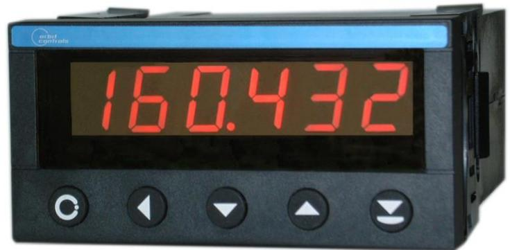
**Modell OC7056A** ist 6-stelliger programmierbarer Kontroller mit 200000 echten Messpunkten, welche über die gesamte Anzeigekapazität von 999999 frei skalierbar sind. Das Gerät ist vorwiegend zum Anschluss an Prozesssignale 0/4-20mA, 20mV bis 300V DC oder echt RMS, DMS Brücken, Pt-100, Pt-200, Thermistoren, Widerstände und DIN-Thermoelemente bestimmt.
