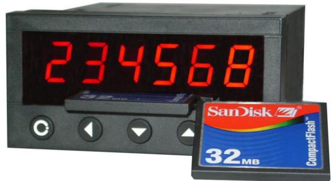
**Modell OC7054 FC** ist ein 6-stelliger programmierbarer Datenlogger zum direkten Anschluss an analoge Prozess-Signale wie 0/4-20mA, 20mV...200VDC oder echt RMS, Temperatursensoren, Potentiometer und andere Signalquellen. Über die Tastatur kann das Eingangssignal am Display skaliert und in gewünschten Prozesseinheiten dargestellt werden. Ein Grenzwertrelais steht für Alarmzwecke zur Verfügung.
