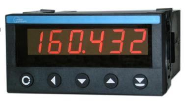
OC7040A programmierbarer ist Kontroller mit 100000 echten Messpunkten, welche über die gesamte Anzeigekapazität von 999999 frei skalierbar sind. Das Gerät ist vorwiegend zum Anschluss an Prozesssignale 0/4-20mA, 20mV bis 300V DC oder echt RMS, DMS Brücken, Pt-100, Pt-200, Thermistoren, Widerstände und Thermoelemente bestimmt.
