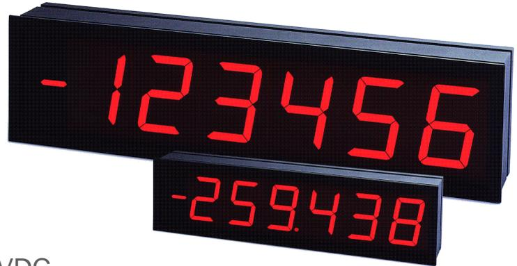
**GROSSANZEIGEN OC57-DC, OC100-DC und OC125-DC** sind 4- oder 6-stellige programmierbare Messgeräte mit  $\pm 200'000$  Messpunkten und wählbaren Eingängen für diverse DC-Prozesssignale wie DMS Brücken,  $\pm 100\text{mV}$ , 1-5V, 4-20mA, etc.
