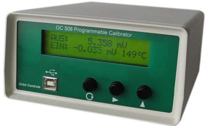
**Modell OC508** ist ein programmierbarer mV-Kalibrator und Simulator von DIN-Thermoelementen. Die Wahl des Thermoelements, der Temperatur oder des mV-Signals kann über die Tastatur, über USB oder als Option über BCD parallele oder binäre Schnittstelle vorgenommen werden. Die generierte mV-Ausgangsspannung liegt im Bereich zwischen 0 und 65.535mV. Sie kann direkt in mV oder in Temperatur gewählt und über eine der gespeicherten Linearisierungstabellen ausgegeben werden.
