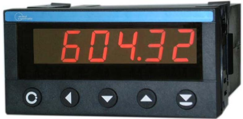
**Modell OC 351-LIN** ist ein 5-stelliger programmierbarer Controller mit 16 Bit Analogwandler, vorwiegend zum Anschluss an Prozesssignale 0/4-20mA, 20mV bis 300VDC oder echt RMS, RTD-Sensoren, Thermistoren, Widerstände, DIN-Thermoelemente, und andere Signalquellen bestimmt.
