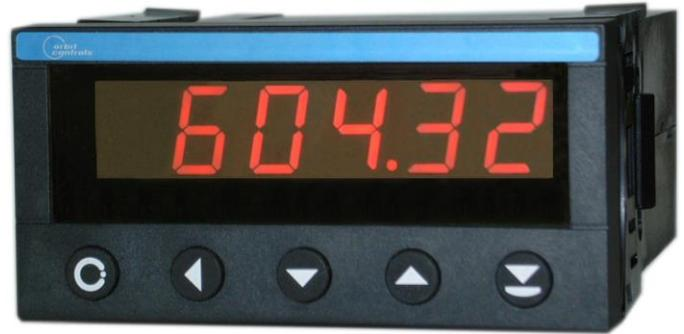
**Modell OC 351** ist ein 5-stelliger programmierbarer Controller mit 16 Bit Analogwandler, vorwiegend zum Anschluss an Prozesssignale 0/4-20mA, 20mV bis 300VDC oder echt RMS, RTD-Sensoren, Thermistoren, Widerstände, DIN-Thermoelemente, und andere Signalquellen bestimmt.
