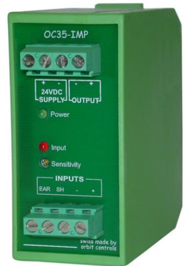
**OC35-IMP** ist ein Messumformer zum Umsetzen von mV-Signalen aus passiven magnetischen Impulsgebern in Rechtecksignale. Der Ausgangssignal-Pegel beträgt wahlweise 5V TTL oder kann im Gerät zwischen 0 und 10V eingestellt werden.
