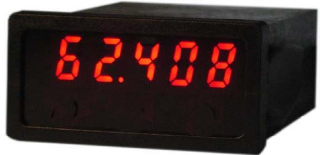
**Modell OC1135** ist ein 5-stelliger Zähler mit programmierbaren Funktionen für Quadraturzähler, Vor-Rückwärtszähler und Tachometer- Drehzahlmesser. Das Gerät ist vorwiegend für industrielle Anwendungen konzipiert, in welchen Quadratur-Drehgeber, induktive Sensoren und andere Impulsquellen angeschlossen werden.
