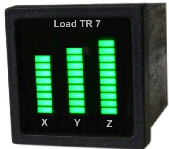
**Balkenanzeige OCB30** mit drei grünen oder roten Balken mit je 10 Segmenten ist zur Darstellung von drei getrennten Eingangssignalen 0-10V bestimmt. Sie wird aus 24VDC oder 24VAC versorgt und in einem DIN-Gehäuse 48 x 48mm untergebracht. Die Einbautiefe beträgt 60mm. Die drei Eingangssignale und die Versorgung werden über Schraubklemmen angeschlossen.
