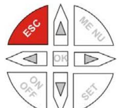
Mit der Taste  **SET** wird der Nullpunkt - TARA - in den Druckkanälen P1 und P2 abgeglichen.
