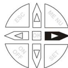
Mit dreifachem **ESC**-Tastendruck wird das Menu beendet und der Messmodus aktiviert.
