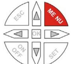
Die Taste  **ESC** ermöglicht drei Rückwärtsschritte im Menu. Danach kehrt das Display in den Messmodus zurück.
