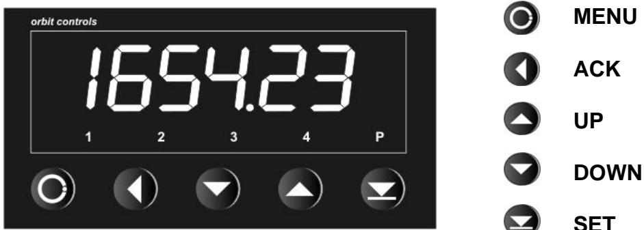
Die Taste **MENU** eröffnet das Gerätemenu. Der gewünschte Parameter wird mit **ACK** bestätigt. Mit **UP** oder **DOWN** werden die Parameter gesetzt.
